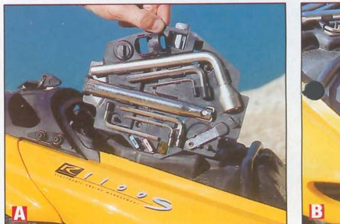
**Sous la selle - A** Les outils ne sont plus rangés dans une trousse, mais disposés sur cette plaque moulée située sur le garde-boue arrière. Les outils sont sur les deux faces de la plaque. **B** Toujours sous la selle, on trouve le manuel d'utilisation et le kit de réparation tubeless.
