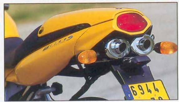
**Façon 916** Les deux silencieux sous la selle offrent l'intérêt de libérer les côtés de la moto pour positionner les repose-pied passager à une hauteur normale. Le capotage de selle, facile à enlever, peut être transporté dans un sac à dos vendu en option.
